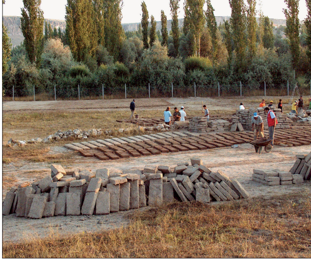
Res. 10. Kerpiç yapımı ve blokların kurutulması
